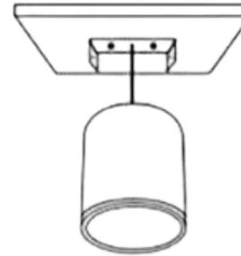
3. Inserte la lámpara en la placa de montaje, apriete los tornillos de ambos lados
