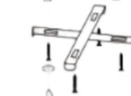
2. Fije la tabla de clavijas dentro del tubo de expansión del techo con tornillos autorroscantes y bloquee firmemente la tabla de clavijas cruzadas con un destornillador.
