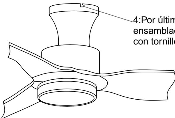
4: Por último, gire y fije la luz del ventilador ensamblada en el soporte preinstalado y apriételo con tornillos.
