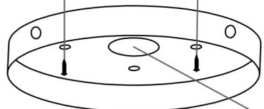
1: El techo de madera se fija al techo mediante 4 tornillos autorroscantes
