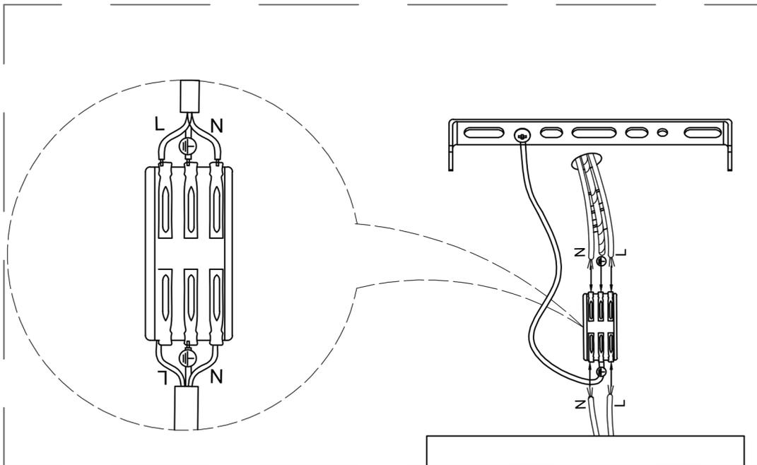
Los cables de la casa están conectados a los cables de la lámpara a través de los terminales de cable.
