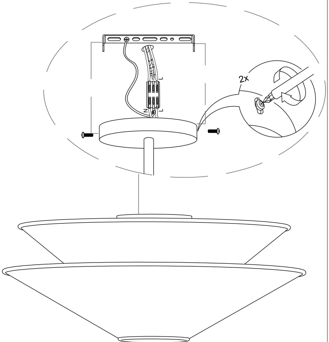
Los tornillos laterales fijan el cuerpo de la lámpara a la placa del techo.
