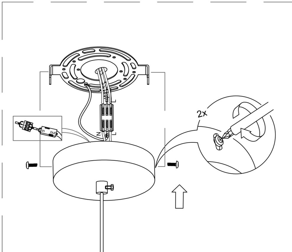
Los tornillos laterales fijan el cuerpo de la lámpara a la placa del techo.
