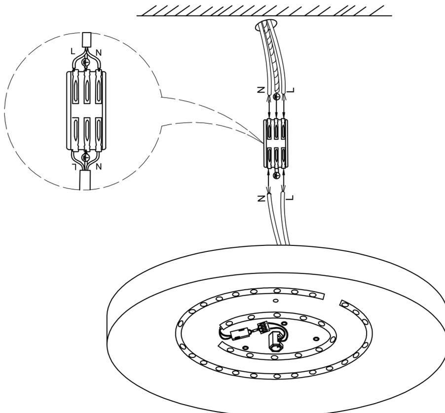
Los cables de la casa están conectados a los cables de la lámpara a través de los terminales de cable.
