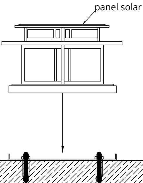
4. Apriete los tornillos laterales para asegurar la base y el cuerpo de la lámpara.
