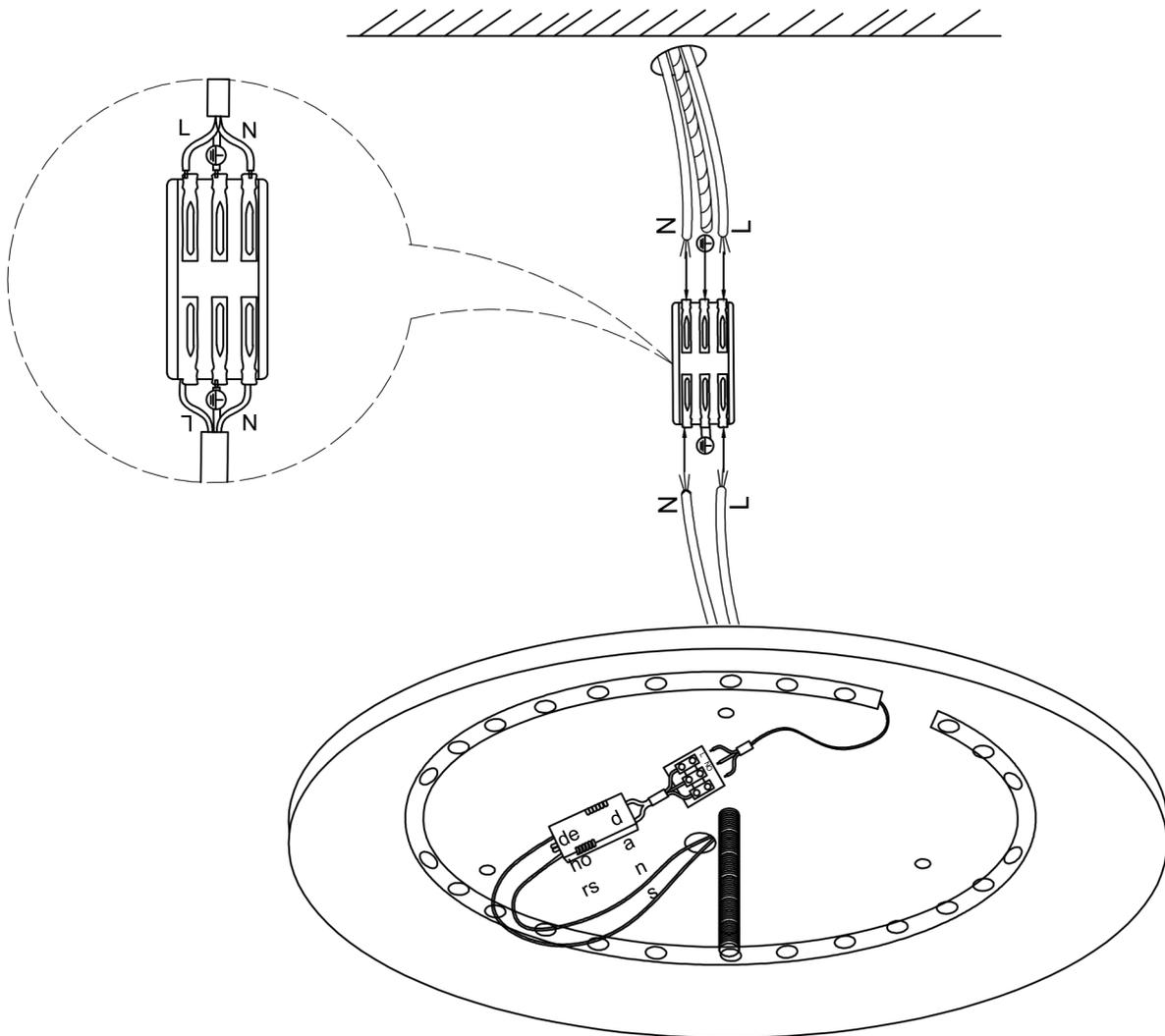
Los cables de la casa están conectados a los cables de la lámpara a través de los terminales de cable.
