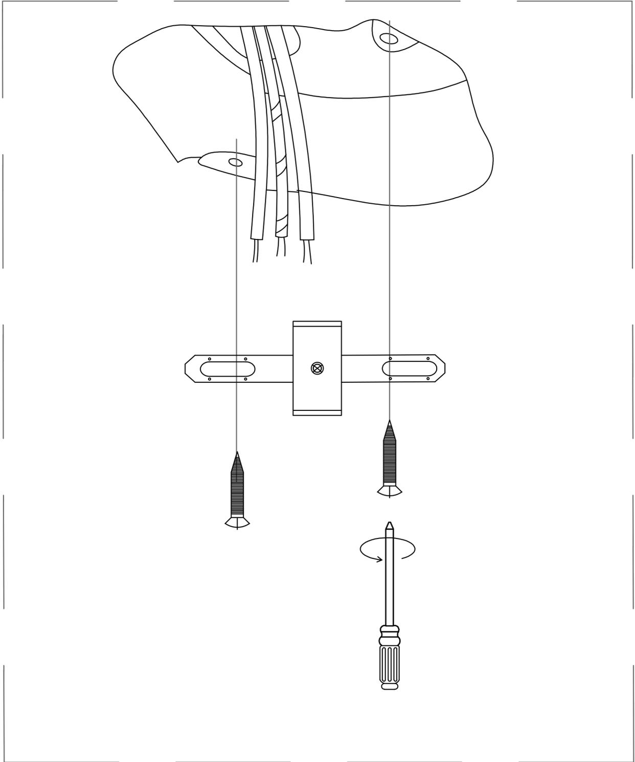
Instale el soporte en la caja por encima del techo.
