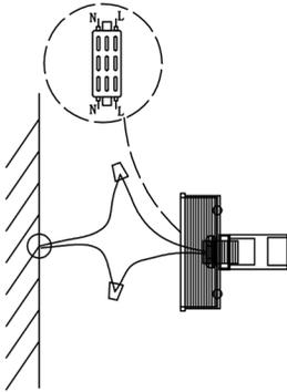
El cable de la casa está conectado al cable de la lámpara.
