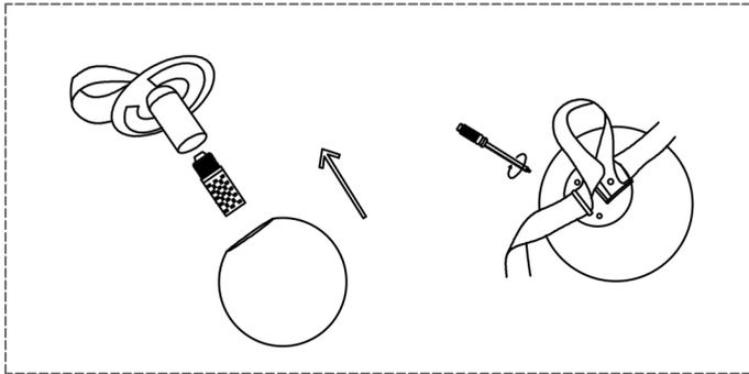
La chapa de hierro con muescas se inserta en la pantalla de la lámpara y se fija con tornillos.
