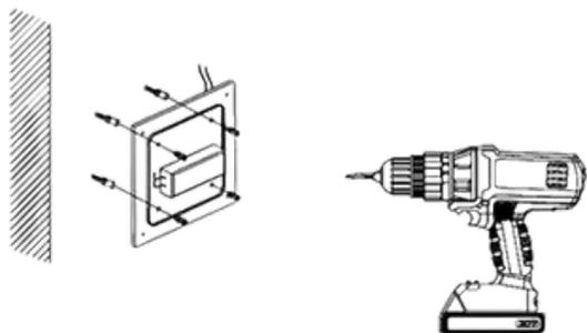
3. Taladre dos orificios en la pared y coloque los dos pernos de expansión de plástico en estos dos orificios. A continuación, fije la base de la lámpara en la pared utilizando los dos tornillos incluidos en el paquete de accesorios.
