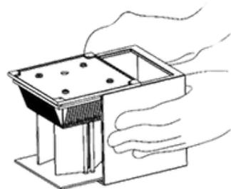
1. Retire la Cubierta exterior del cuerpo Principal de la lámpara de pared.
