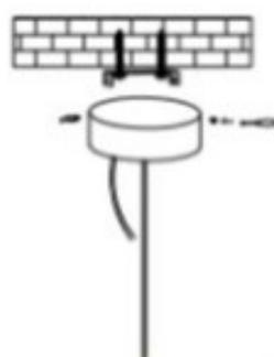
Coloque el cable y el terminal en la copa del techo y conecte la copa del techo y la placa colgante con tornillos.
