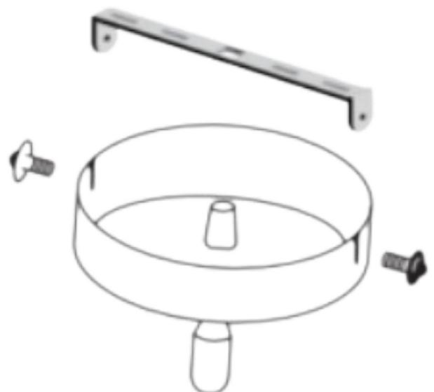
4. Utilice los tornillos pequeños del kit en el lado de la placa del asiento para fijar el chasis y la placa colgante.
