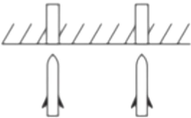
1. Utilice una broca para estimar dos agujeros en el techo. Alinee los agujeros con los agujeros del tablero de clavijas y luego márquelos en la pared con tornillos de expansión.
