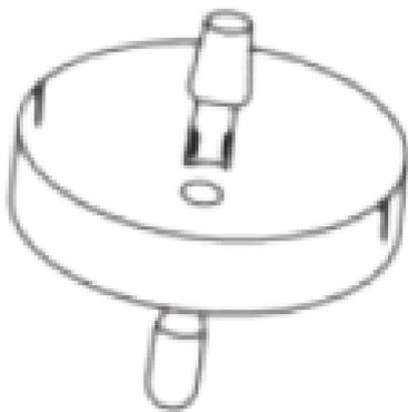
3. Ajuste la longitud del cable hasta que sea la adecuada. (Si el cable de la lámpara es largo, puede cortarlo adecuadamente). Luego, conecte el cable de fuego al cable de fuego de la lámpara.
