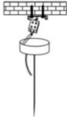
El cable de alimentación y el cable de la lámpara están conectados, y la conexión debe ser firme, sin conexiones incorrectas.
