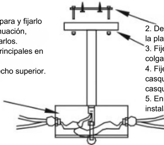
2. Determine la posición de instalación y fije la placa colgante
