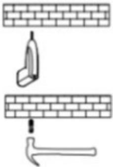
1: Perfore los agujeros de montaje de acuerdo al techo de la placa de suspensión. 2. Martille el tubo de expansión en el agujero de montaje.
