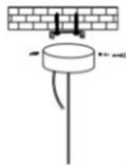
Inserte el cable y el terminal en la copa del techo y conecte la copa del techo y la placa de suspensión con tornillos.
