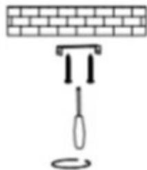
Asegure la placa de suspensión al techo con tornillos.
