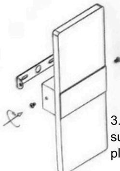
3. Utilice los tornillos de la placa de suspensión para apretar la lámpara y la placa de suspensión desde arriba.
