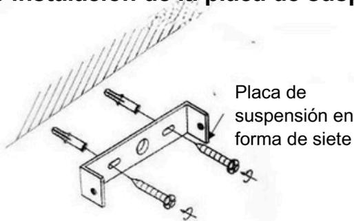
1. Fije la placa de suspensión a la pared con tapones de expansión de tornillos autorroscantes.
