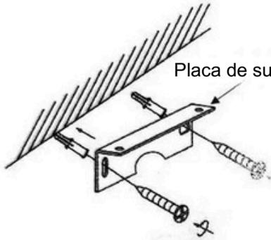
1. Fije la placa de suspensión a la pared con tapones de expansión de tornillos autorroscantes.
