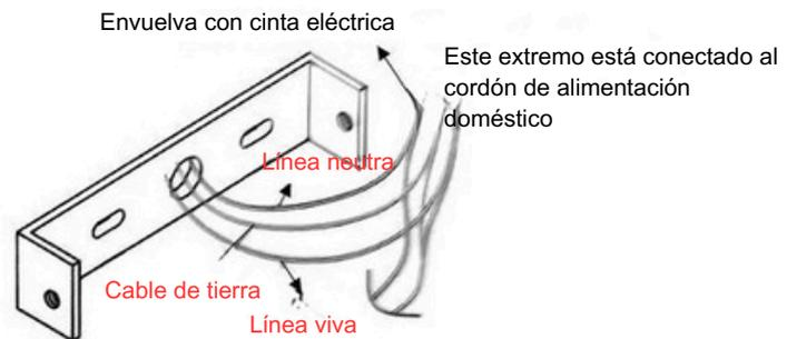
2. Conecte los cables reservados a los cables de alimentación de la lámpara.
