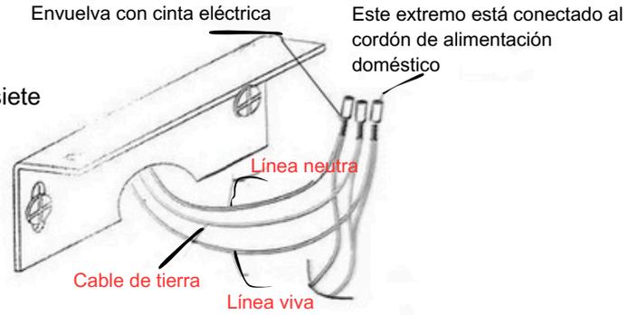
2. Conecte los cables reservados a los cables de alimentación de la lámpara.
