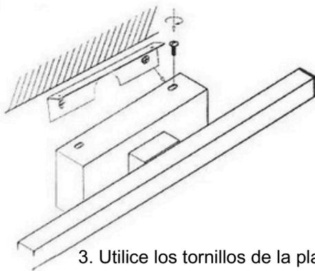
3. Utilice los tornillos de la placa de suspensión para apretar la lámpara y la placa de suspensión desde arriba.
